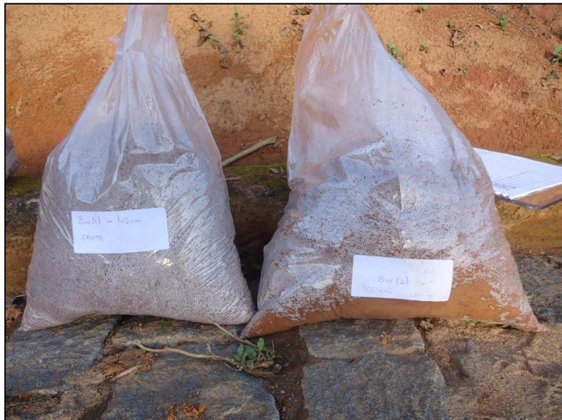
**Figura 17** – Amostras deformadas coletadas em campo.
