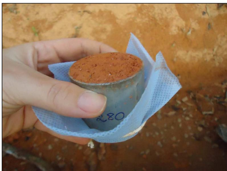
**Figura 18** – Coleta de amostra indeformada em anel volumétrico.
