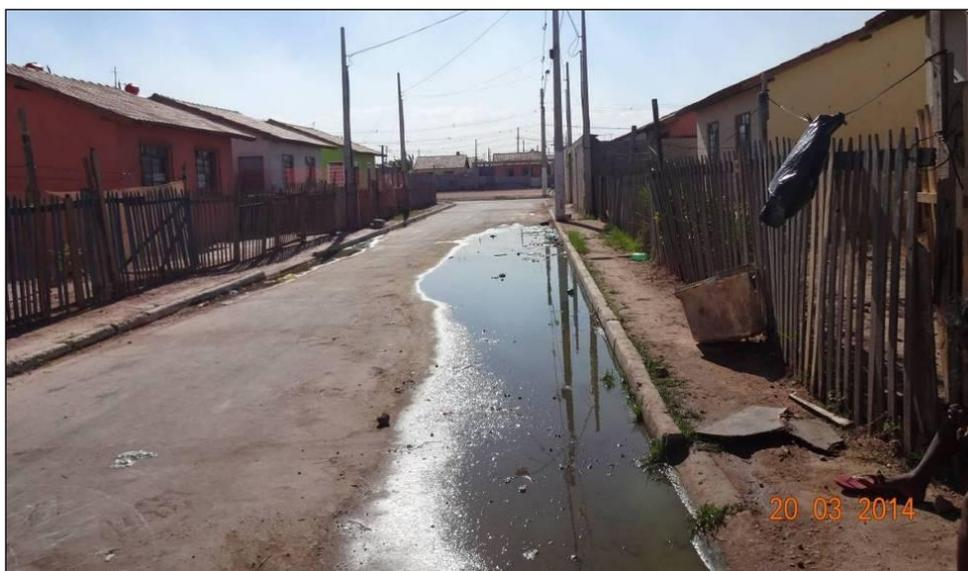
Figura 25 – Vazamento de esgoto no conjunto habitacional entregue em 2011 pelo Estado localizado no bairro Jabaeté, Vila Velha.
