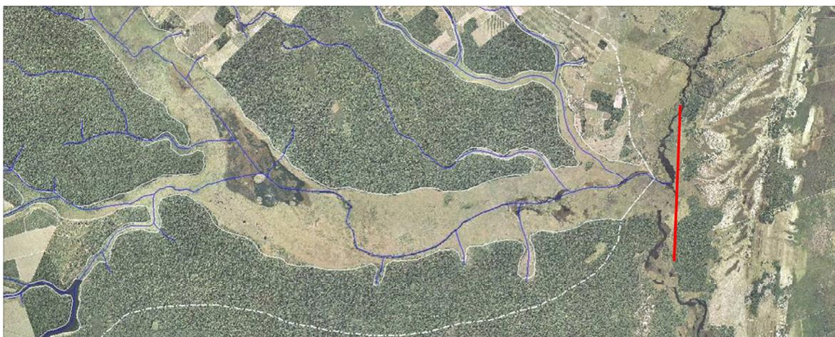
Figura 4.16: represamento natural provocado por cordões arenosos pleistocênicos (linha vermelha) na área de contato do Rio Barra Seca com a Planície Quaternária do Suruaca (imagem: ortofotomosaico lema/Vale, 2008).
