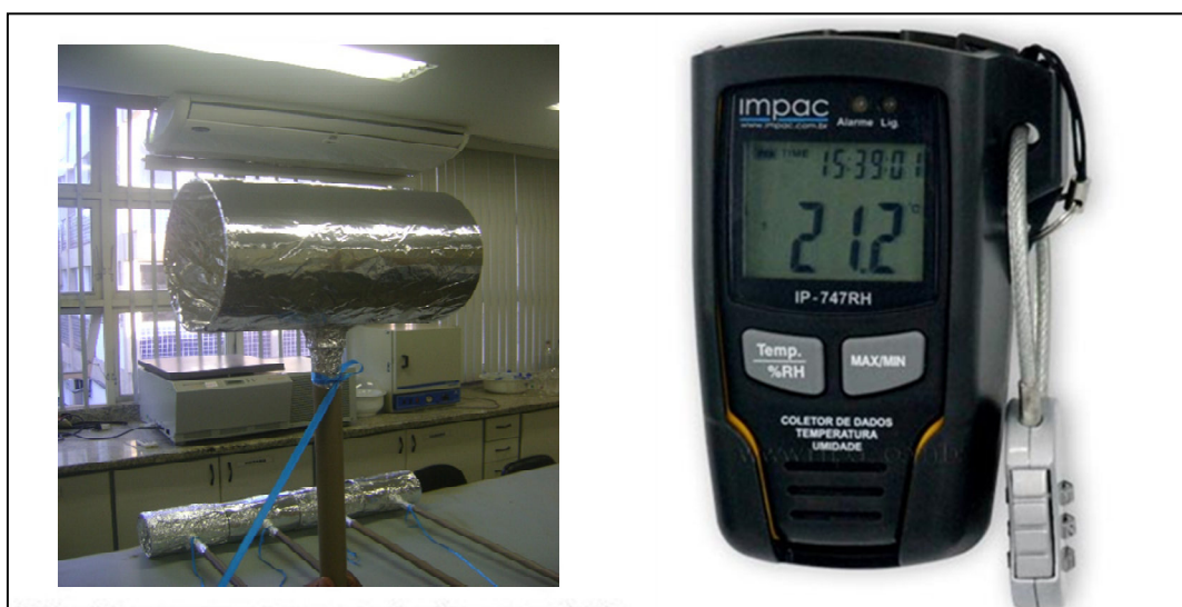
Figura 15: Tubo de PVC 100 cm x 50 cm para encanamento de água envolvido com papel alumínio e Datalogger IP-747 RH, Temperatura e Umidade USB.
